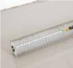
Aerați suprafața cu o rolă cu arc
